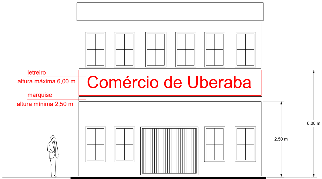
ART.259/260 - VEÍCULO DE DIVULGAÇÃO EM MARQUISE VISTA FRONTAL letreiro não pode ultrapassar limite da edificação
